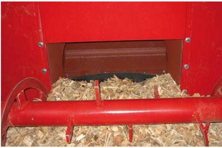
Die Austragung der Hackschnitzel erfolgt schonend und effektiv mit der leistungsstarken **Tropper** - Hackgut-Schleuse.
