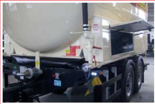
Das geringe Eigengewicht macht Silo-Anhänger besonders attraktiv, da die Nutzlast relativ hoch im Vergleich zum LKW-Aufbau sein kann. Wie ein Silofahrzeug kann auch der Siloanhänger mit integrierten Sackkästen und großflächigen Schlauchrohrverkleidungen ausgerüstet werden.
